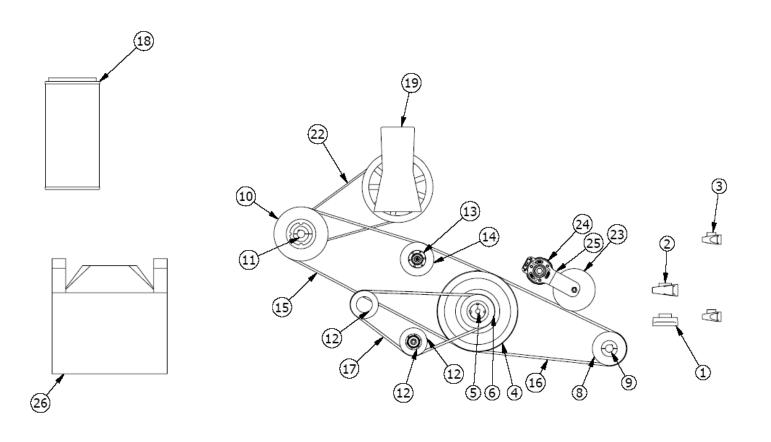
FIGURE 13B: BELT/SHEAVE ASSEMBLY - SIDE VIEW
