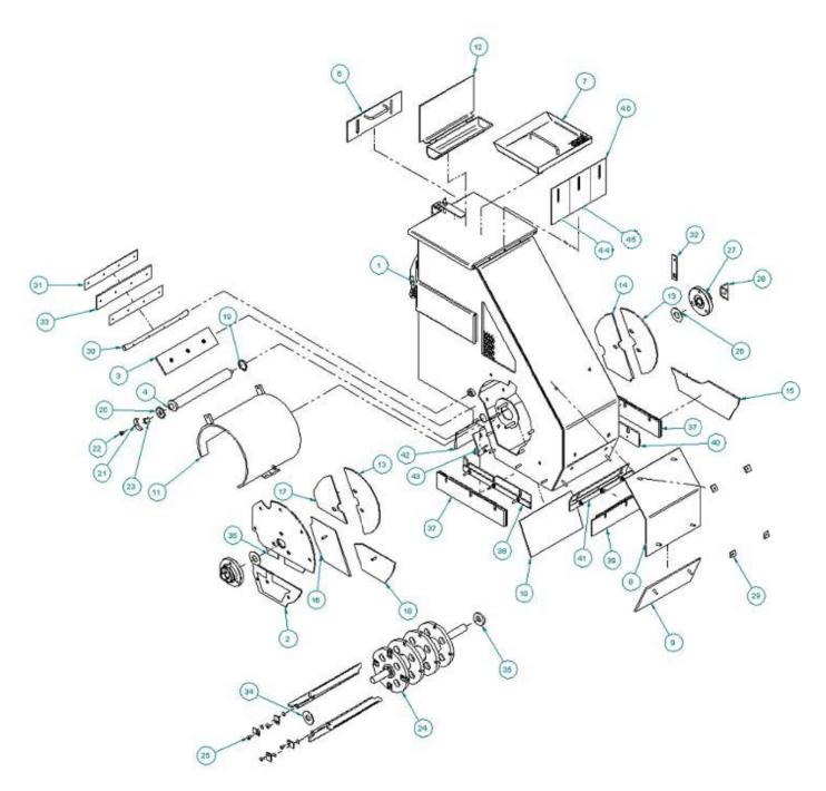
FIGURE 14: BLAST HEAD COMPONENTS EXPLODED VIEW
